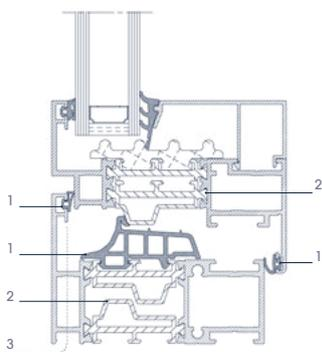
\*Le joint extérieur empêche le vent, l'eau et la poussière d'entrer. Le joint central protège la quincaillerie. Le joint intérieur assure une isolation acoustique supplémentaire de -3 dB.
